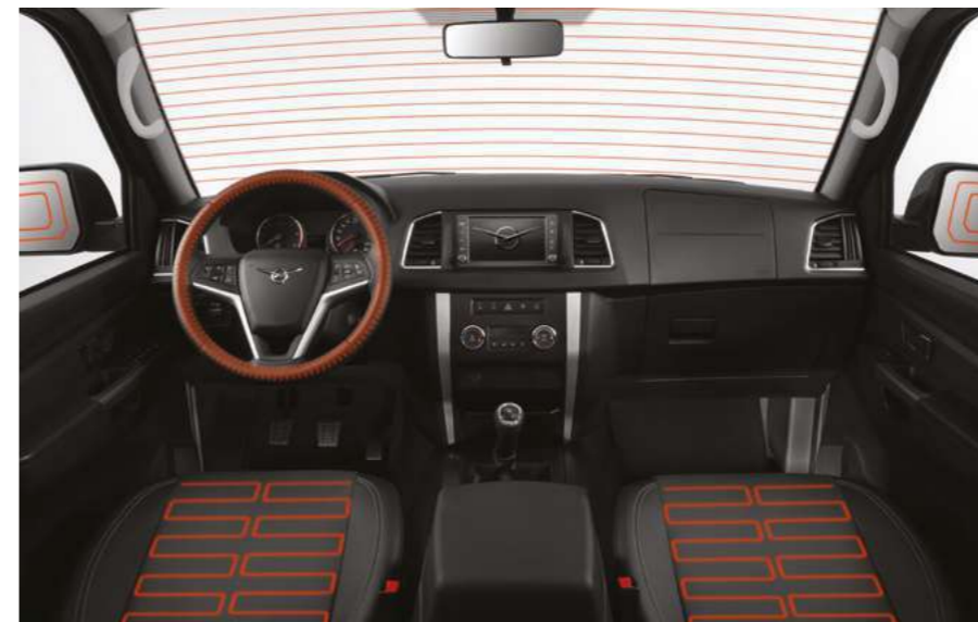
Обогрев рулевого колеса, передних сидений, лобового стекла, боковых зеркал и заднего стекла
